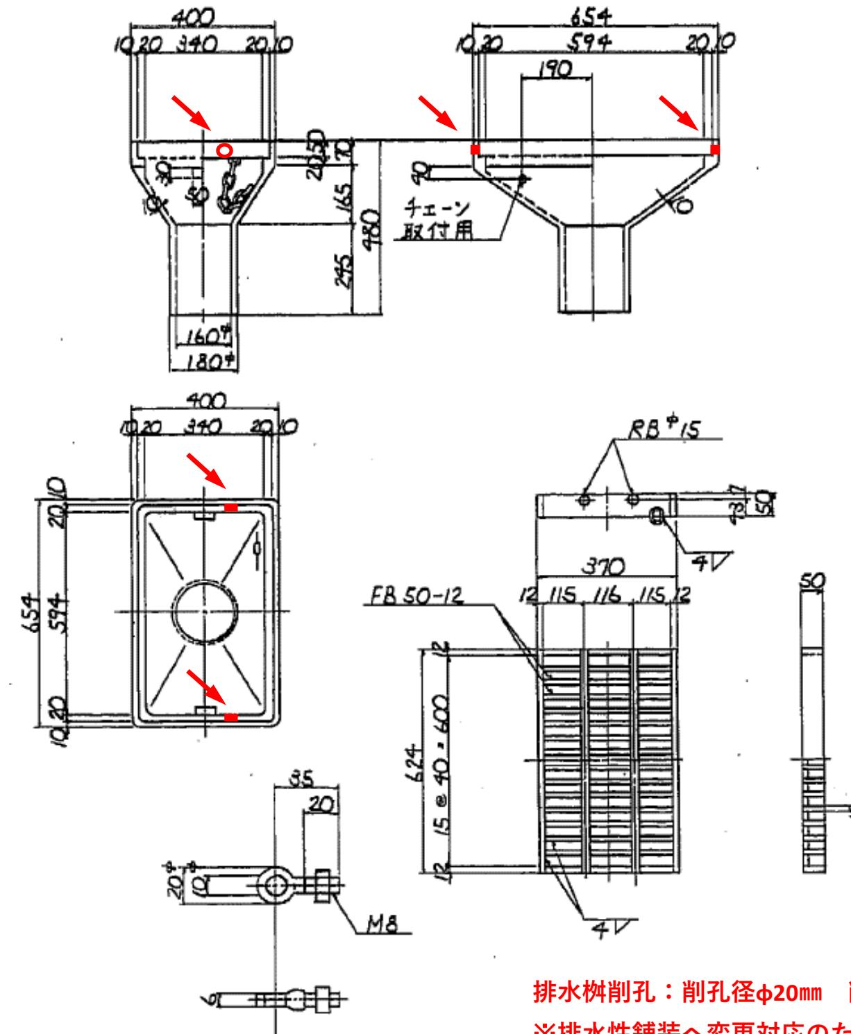
排水樹削孔：削孔径Φ20mm 削孔厚10mm 各樹削孔2箇所
