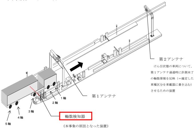
車輪の数(軸数)を計測する装置 ※けん引状態の車両は、軸数の合計数に応じて車種区分を判定する
