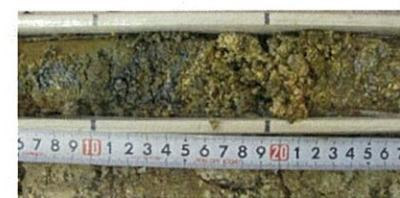
GL-2.75m 崖錐堆積物と風化花崗岩の境界部
