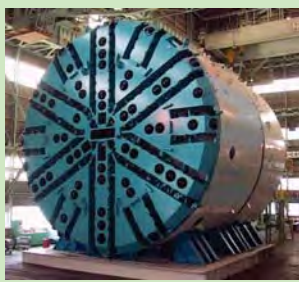
大断面・岩盤対応 泥水式シールドの例
