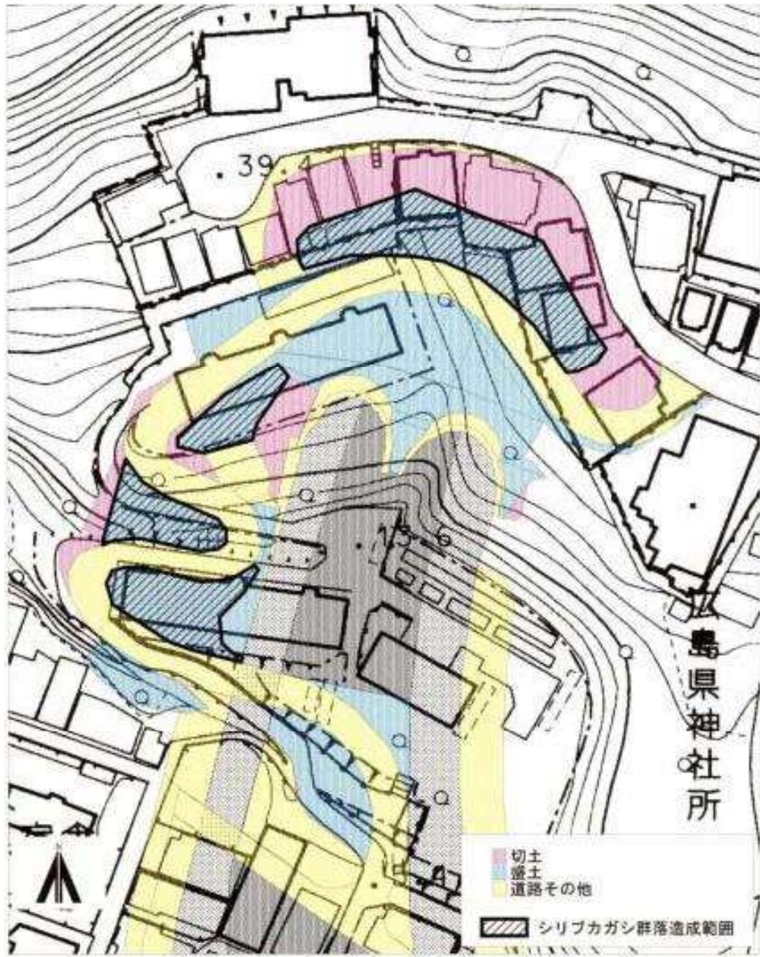
図 シリブカガシ群落造成法面
